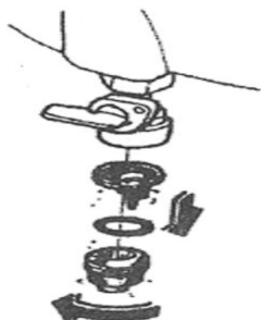
Снятие фильтрующего элемента топливного фильтра
