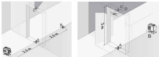
Повторите вышеописанную процедуру для второй вертикальной плоскости. Максимально допустимое отклонение высчитывается по формуле: высота проёма x 2 x 0,2 мм/м.
