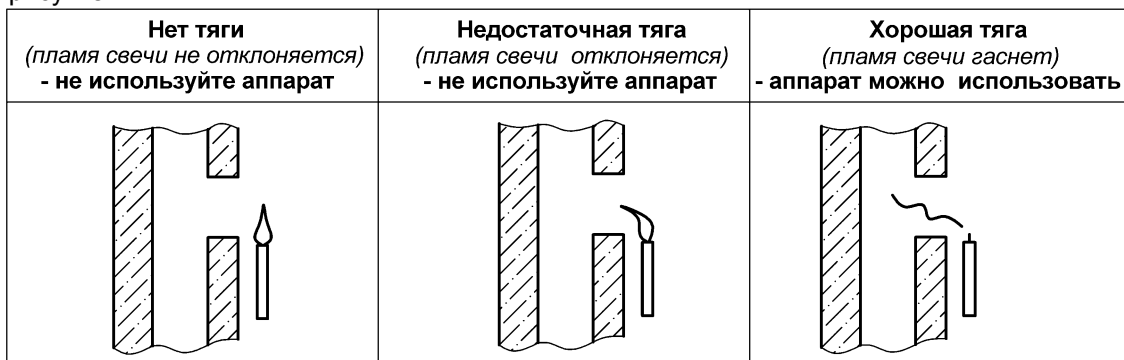
Рисунок 7. Способ проверки тяги в дымоходе
