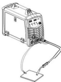
**Подключение безгазового сварочного пистолета**
