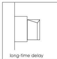
Примечание: Если к выходу регулятора напряжения подключены холодильники, воздушные кондиционеры или другие приборы, тогда внутренний воздушный компрессор не может постоянно находиться под напряжением, поскольку это может повредить сам компрессор. Поэтому должен быть выбран режим длительной задержки.
