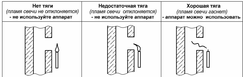
Рисунок 4. Способ проверки тяги в дымоходе
