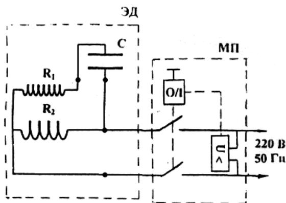
ЭД – электродвигатель, МП – магнитный пускатель.
