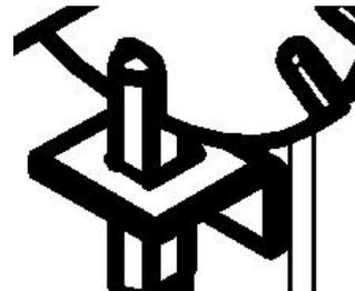
5.4 Смонтировать раму монтажную (6) на основание переднее (3) так, чтобы кончик фиксатора (8) прошёл через уголок рамы монтажной (6), как показано на рисунке справа.
