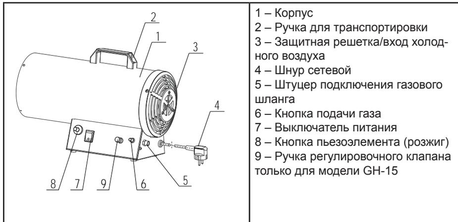
Для газовых тепловентиляторов GH-30, GH-50, GH-70.
