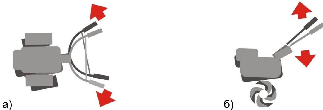
Рис.7 Схемы снятия нагрузки с валов при использовании механизма разобщения полуосей
