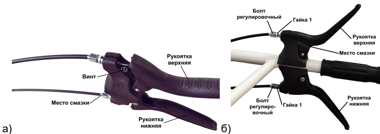
Рис.11 Рычаги разобщения полуосей (колес) мотоблока (вариант 2)
