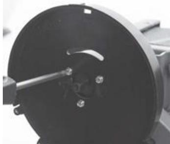
Наживите установочный винт «А» из комплекта на основание шлифовального диска. Установите основание шлифовального диска на вал так, чтобы установочный винт оказался на плоской части вала.
