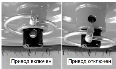
Рис. 28 Перестановка шплинта на левом колесе
