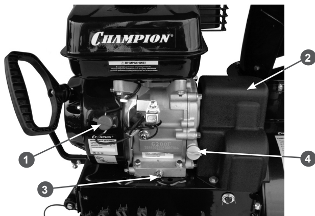
Рис. 3 Основные узлы и органы управления двигателя (вид справа)
