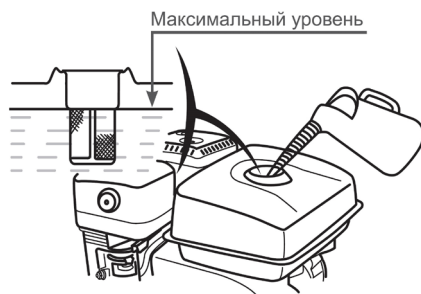
Рис. 20 Максимальный уровень топлива в топливном баке
