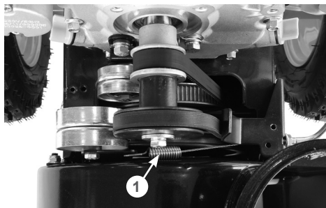
Рис. 9 Регулировка троса включения шнеков
