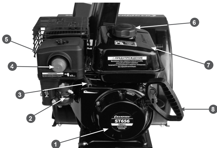
Рис. 2 Основные узлы и органы управления двигателя (вид сзади)
