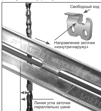
Рис. 18 Определение угла заточки
