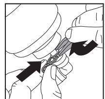
8. Наденьте пары нижних фитингов, соединенные трубками, на новые фильтрующие элементы: сначала соедините снизу между собой фильтрующие элементы 1-й и 2-й ступени, затем – 3-й и 4-й.
