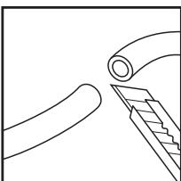
При монтаже пластиковая трубка (шланг) разрезается на две части (длина частей выбирается на месте). Одним отрезком соединяют шаровый кран (1) с входным фитингом корпуса фильтра (расположен горизонтально). Вторым отрезком соединяют выходной фитинг корпуса фильтра (расположен вертикально) с краном для чистой воды (3).
