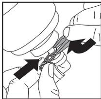
8. Наденьте пары нижних фитингов, соединенные трубками, на новые фильтрующие элементы: сначала соедините снизу между собой фильтрующие элементы 1-й и 2-й ступени, затем – 3-й и 4-й.
