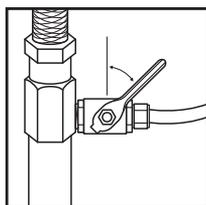
После установки фильтра Expert осторожно откройте подачу холодной воды краном (1) и убедитесь в герметичности всех соединений. Если
