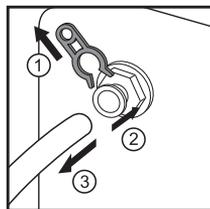
Для отключения шланга (заглушки или патрубка фильтрующего элемента) от фитинга следует: открыть замок фитинга (т.е.
