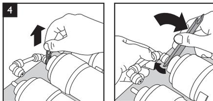
4. Последовательно снимите 4 верхних фитинга с фильтрующих элементов.
