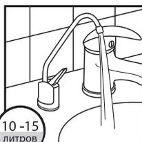
Установите (отрегулируйте) максимальный расход воды через фильтр Expert с помощью шарового крана (1) на уровне 1-2 л/мин,
