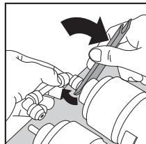
4. Последовательно снимите 4 верхних фитинга с фильтрующих элементов.
