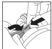
10. Наденьте верхние фитинги на фильтрующие элементы: сначала подсоедините верхний фитинг фильтрующего элемента 1-й ступени, затем соедините сверху между собой филь-
