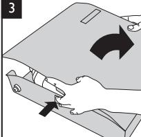
3. Расположите корпус фильтра на горизонтальной поверхности (на столе). Откройте крышку фильтра.
