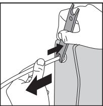
2. Отсоедините пластиковые трубы от входного и выходного фитингов на корпусе фильтра.
