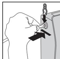
11. Закройте крышку фильтра. Установите фильтр на место и подсоедините пластиковые трубки к входному и выходному фитингам.
