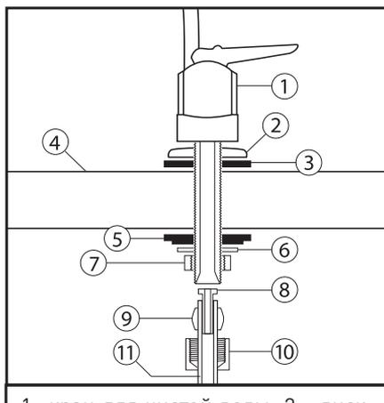
1 - кран для чистой воды; 2 - диск-подставка; 3 - резиновая опора; 4 - мойка / столешница; 5 - прижимное крепление; 6 - шайба; 7 - гайка; 8 - вставка; 9 - обжимное кольцо; 10 - гайка; 11 - пластиковая трубка.
