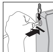
11. Закройте крышку фильтра. Установите фильтр на место и подсоедините пластиковые трубы к входному и выходному фитингам.
