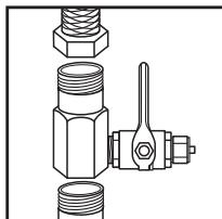
■ Установить в водопроводную магистраль холодной воды тройник и шаровый кран (1). Внимание! При установке этих элементов не перетягивайте соединения! Это может привести к разрушению тройника или крана, в том числе - к скрытому (с отдаленными последствиями). Коли-
