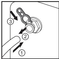
т.е. временно снять его, затем вставить шланг/патрубок рукой до упора в отверстие фитинга и зафиксировать шланг/патрубок возвратным движением концевого зажима (цанги) фитинга, установить замок на прежнее место: 1 - втолкнуть рукой; 2 - вытянуть ключом; 3 - вставить. При этом вытягивание цанги фитинга производится с помощью специального ключа: вставьте «вилку» ключа в зазор между основанием фитинга и цангой и отведите цангу от основания, действуя ключом как рычагом.
