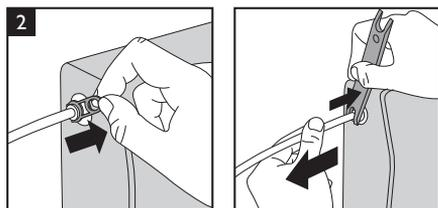
2. Отсоедините пластиковые трубки от входного и выходного фитингов на корпусе фильтра.
