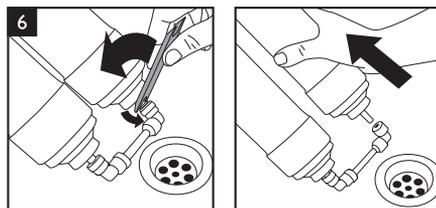
6. Поместите каждую извлеченную пару фильтрующих элементов в раковину мойки. Снимите нижние фитинги с фильтрующих элементов.
