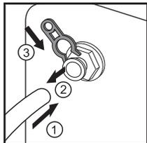
Для подключения шланга (или патрубка фильтрующего элемента) к фитингу следует: открыть замок фитинга – подковообразную защелку,
