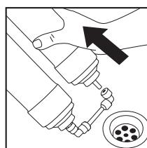
6. Поместите каждую извлеченную пару фильтрующих элементов в раковину мойки. Снимите нижние фитинги с фильтрующих элементов.
