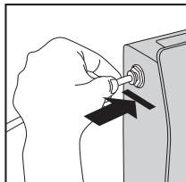
Для подключения шланга (или патрубка фильтрующего элемента) к фитингу следует: открыть замок фитинга – подковообразную защелку,
