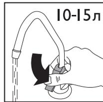
12. Откройте шаровый кран подачи воды к фильтру, проверьте герметичность соединений.
