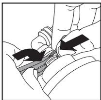
10. Наденьте верхние фитинги на фильтрующие элементы: сначала подсоедините верхний фитинг фильтрующего элемента 1-й ступени, затем соедините сверху между собой филь-
