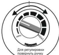
Регулировка времени задержки освещения
