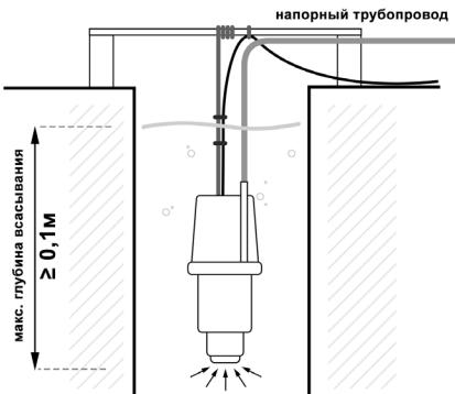
Максимальный напор - это максимальное расстояние подачи воды от насоса без перегибов и наклонов напорного шланга.
