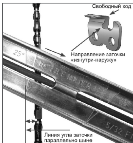
Рис. 28 Определение угла заточки
