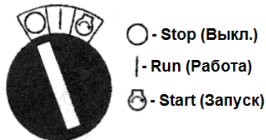
Рис.12. Замок зажигания (электростартер). Ключ в положении "O" (Выкл.).
