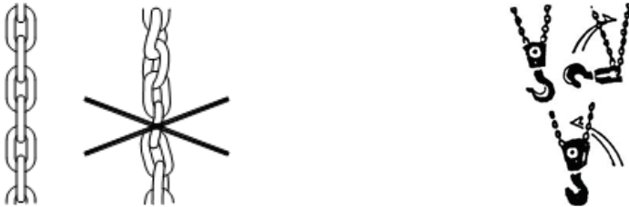
Рис. 2 Положение грузовой цепи; Рис. 3 Неправильное положение крюка
