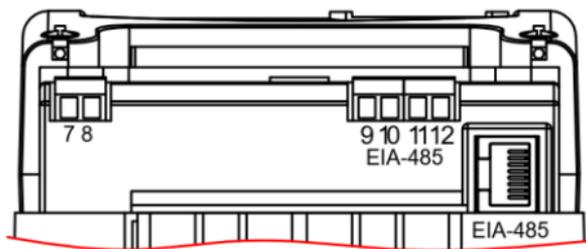
обозначение контактов счетчика с двумя интерфейсами EIA-485
