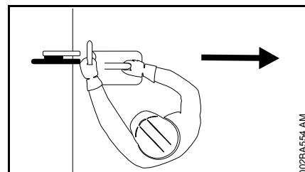
Следить за тем, чтобы в расширенный диапазон поворота абразивно-отрезного круга не попадали части тела. Следить за тем,
