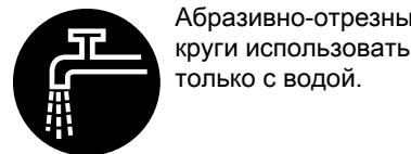
Для связывания пыли к абразивно-отрезному кругу следует подавать воду в количестве минимум 1 л/мин. Чтобы не снижать мощность реза, к абразивно-отрезному кругу следует подавать воду в количестве максимум 4 л/мин.
