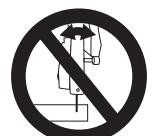
Абразивно-отрезной круг вводить в разрез прямо, не перекаивать и не подвергать боковой нагрузке.
