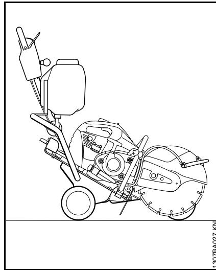
Аbrasивно-отрезное устройство может монтироваться на направляющей тележке STIHL FW 20 (специальные принадлежности) всего лишь в несколько приемов.
