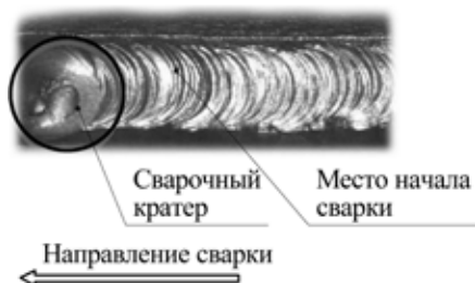
Рис. 7.4. Начало сварки при смене электрода.
