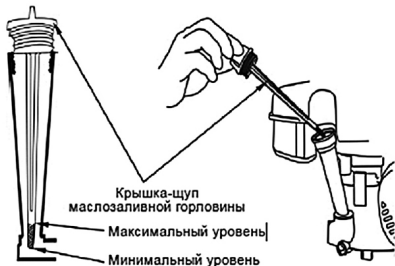
Рис.8 Проверка уровня масла в картере
