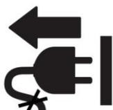
**⚠ Внимание! При повреждении или разрыве сетевого шнура немедленно выньте его вилку из штепсельной розетки!**
