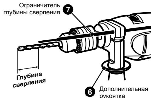
Ограничитель глубины сверления используется для сверления отверстий определенной глубины.
