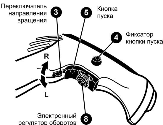
Кнопка пуска оснащена фиксатором для длительной работы.
