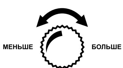
Ваша дрель оснащена плавным регулятором частоты вращения двигателя. Чем сильнее Вы нажимаете кнопку пуска 5, тем выше частота вращения. Верхний предел частоты вращения можно изменить с помощью специального колесика 8, расположенного на кнопке пуска 5. Для увеличения верхнего предела частоты вращения, вращаете колесико по часовой стрелке, а для уменьшения, против часовой стрелки, согласно пиктограмме на колесике.
