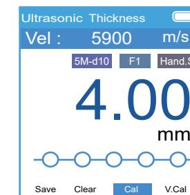
При этом по умолчанию устанавливается скорость звука равная 5900 м/с. Далее нанесите тонкий слой контактного геля на площадку для калибровки. Прижмите датчик к поверхности площадки. Дождитесь завершения процесса калибровки. После этого прибор автоматически вернется в режим измерения.
