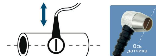
**Для измерения диаметра цилиндра** – необходимо, кроме подготовки поверхности и нанесения связующего вещества, во время измерения установить ось датчика перпендикулярно оси цилиндра, и перемещая датчик по оси (результат будет меняться) – минимальное значение будет соответствовать диаметру цилиндра.
