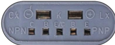
Определите тип проверяемого транзистора **NPN** или **PNP**, вставьте ножки в разъёмы колодки в соответствии с его цоколёвкой и проводимостью. На дисплее будет отображён результат измерения коэффициента передачи (усиления).
