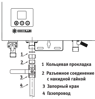
Подсоединение газопровода
