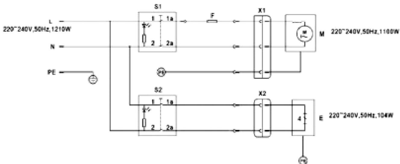
Рис. 3. Электрическая схема.
