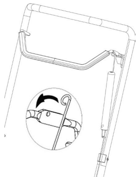
Рис. 2 Установка рычага и троса привода шнека
