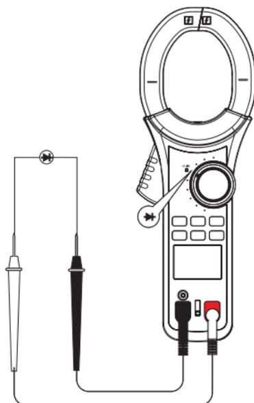
Рис. 7 Проверка диода
