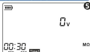
4 Нажмите кнопку «ТЕСТ» и поверните ее по часовой стрелке. В это время прибор начнет измерять сопротивление, и вести обратный отсчет времени. Периодически будет звучать звуковой сигнал, а значок таймера «TIME1» будет мигать. Во время теста на дисплее отображается следующее: 6
