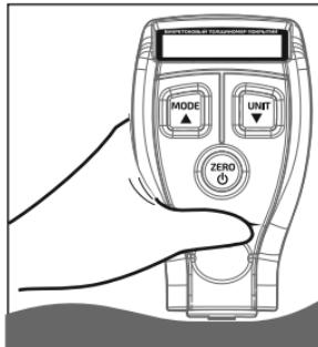
**▲ Неровность покрытия и шероховатость основания может влиять на точность измерений.**
