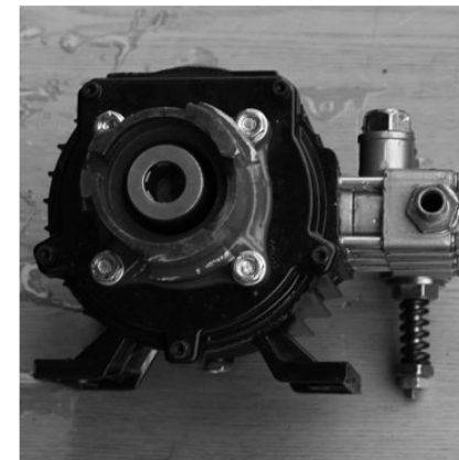
ШАГ 3 Установите переходник на шлицевой вал помпы высокого давления.
