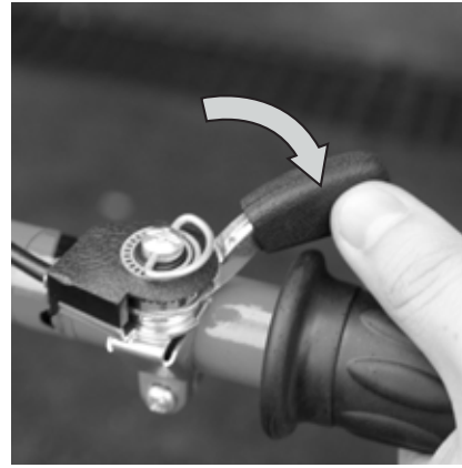
ШАГ 8 Установите минимальные обороты двигателя, переведя рычаг газа в положение по часовой стрелке.
