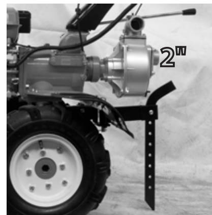
ШАГ 6 Подсоедините к помпе шланги соответствующего размера.
