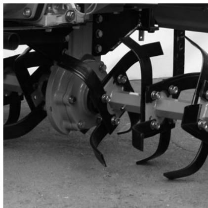
ШАГ 19 Соедините почвенные фрезы с выходным валом редуктора.
