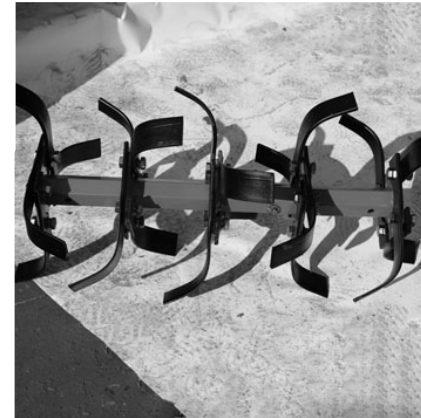
ШАГ 18 Соедините части вала при помощи соединительного пальца и шплинта.
