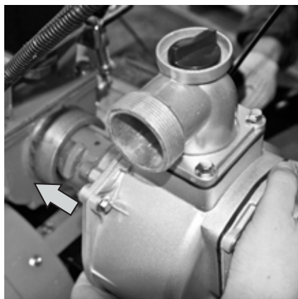
ШАГ 4 Установите помпу в установочную полость вала отбора мощности.
