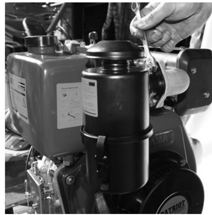
ШАГ 11 Закрепить воздушный фильтр к впускному коллектору.
