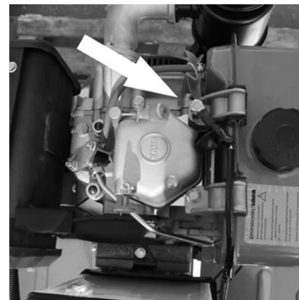
ШАГ 27 Подсоедините «-» провод к корпусу.
