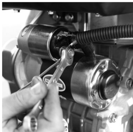
ШАГ 25 Подсоедините второй конец «+» провода к клемме электростартера.
