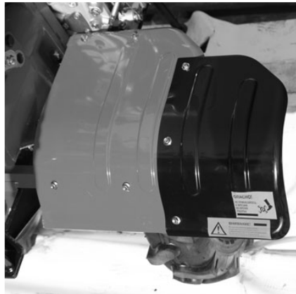
ШАГ 16 Установить и закрепить защитные кожухи.
