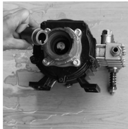
ШАГ 2 Помпа высокого давления в комплекте имеет переходник со шпонкой.
