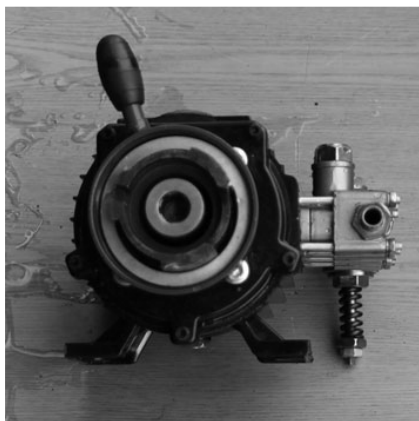
ШАГ 4 Наденьте фиксирующее кольцо на помпу высокого давления.
