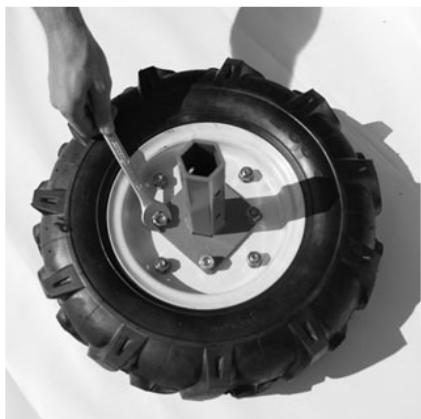
ШАГ 1 Закрепите ось колеса к колесному диску с помощью крепежа.
