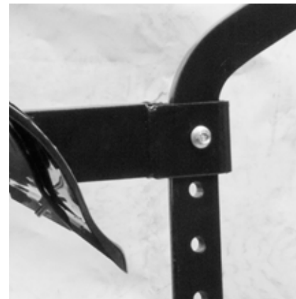
ШАГ 21 Вставьте сошник в держатель и закрепите его болтом.
