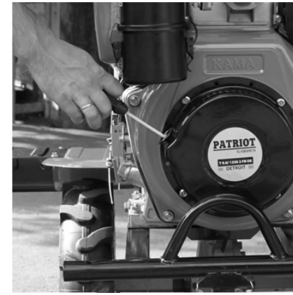
ШАГ 9 Вытяните запускной шнур стартера до момента, пока не появится усилие. Произведите запуск двигателя, вытянув запускной шнур стартера на 3/4 его длины, если двигатель не заводится, повторите операцию.
