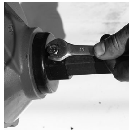
ШАГ 3 Закрепите пыльник фиксатором.
