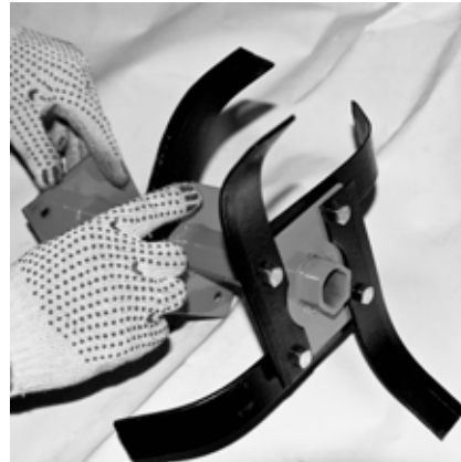
ШАГ 17 Соберите почвенную фрезу, прикрутив режущие ножи при помощи крепежа.
