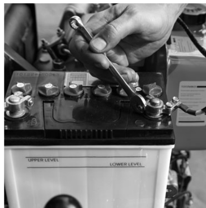
ШАГ 26 Подсоедините «+» провод к аккумулятору.
