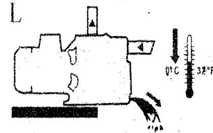
Во время длительного простоя насоса при температуре окружающего воздуха ниже 0°C, корпус насоса должен быть полностью опорожнен от воды через сливное отверстие в нижней части насоса (рис.L). Это предотвращает поломку гидравлических деталей из-за замерзания воды.
