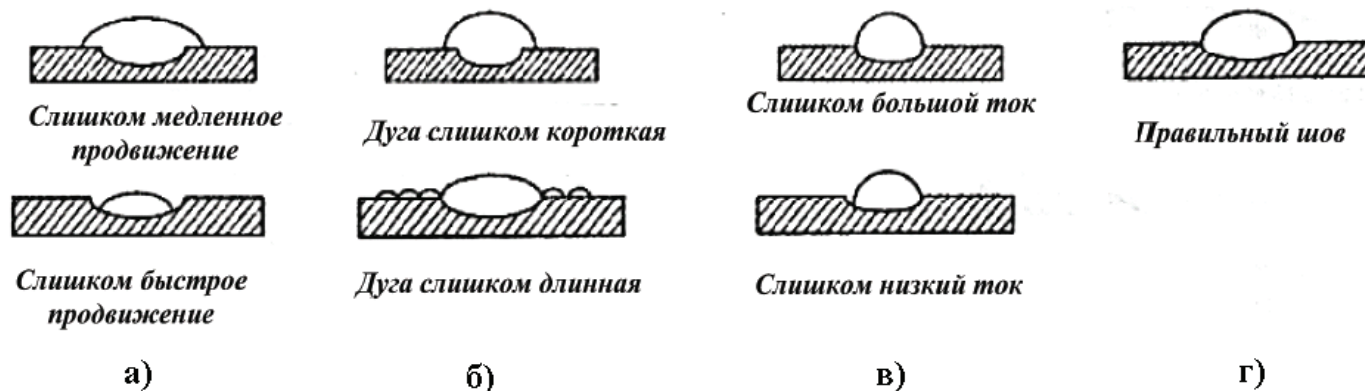
Рис.3. Типы сварочных швов
