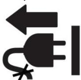
**⚠ Внимание! При повреждении или разрыве сетевого шнура немедленно извлеките его вилку из штепсельной розетки!**
