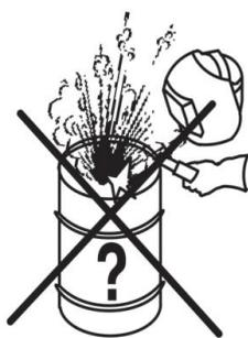
**⚠ Внимание!** Не производите сварочные работы на закрытых сосудах, находящихся под давлением (баллоны, трубопроводы и т.д.), также на сосудах содержащих воспламеняющиеся или взрывоопасные вещества!
