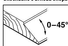
При изработване на стъпала под наклон установете желания ъгъл с помощта на регулиращата гайка **23**.
