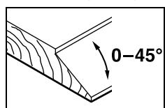
Podesite kod iskošenja falca i površina potrebnu ugao iskošenja sa podešavanjem ugla **23**.
