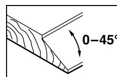
Настройте нужный угол скашивания четверти и поверхности с помощью гайки настройки угла 23.
