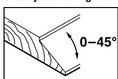
Kod skošenja ureza i površina namjestite potreban kut skošenja sa maticom za utvrđivanje **23**.
