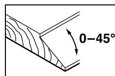
Pri poševnem odrezanju posetih robov in površin nastavite potreben kot z nastavitevijo globine **23**.
