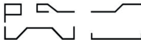
Рис. 5 Формы изгиба арматуры
