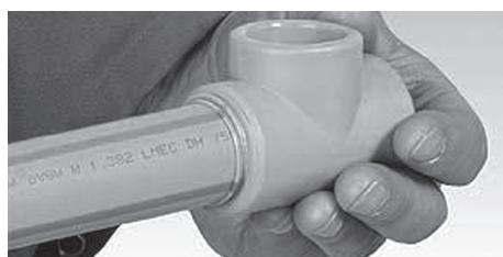
**ПРИМЕЧАНИЕ!** При охлаждении поворачивание трубы/фитинга не допустимы. В противном случае соединение может получиться не герметичным и не прочным.
