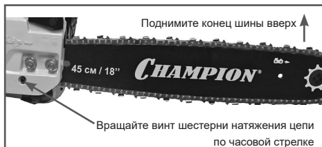
Рис. 5 Регулировка натяжения цепи
