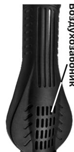
**ПАЯЛЬНИК:** Включите паяльник и дождитесь когда он нагреется до установленной температуры, подождите 20..30 сек. для равномерного разогрева и стабилизации температуры – можно приступать к работе. По окончании использования выключите паяльник.
