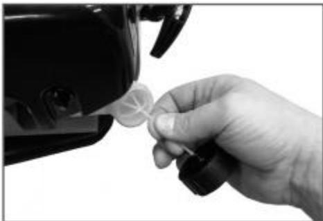
Рис. 14 Снятие крышки топливного бака
