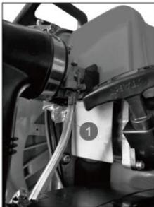
**Рис. 9 Ручной топливный насос**
