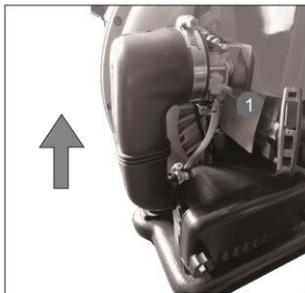
**Рис. 10 Воздушная заслонка карбюратора закрыта**
