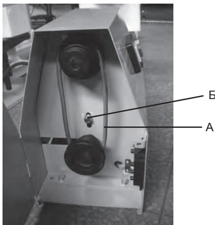
Ослабьте крепежный болт электродвигателя (Б). Установите ремень на необходимые шкивы. Натяните ремни перемещением электродвигателя вниз, таким образом, чтобы при приложении нагрузки к ремню в 2 кг, он прогнулся на 1 см, и зафиксируйте его, вновь затянув крепежный болт (Б).
