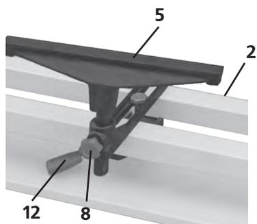
Для изменения высоты опоры ослабьте винт фиксации высоты опоры (8). Установите опору на необходимую высоту и зажмите винтом (8). Проверните заготовку рукой, убедитесь, что она свободно вращается и не касается опоры.
