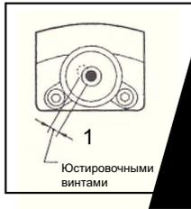
5. Повторяйте описанные выше действия до полного устранения смещения пузырька при повороте прибора.
