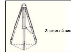
2. Не раскладывая штатив, вытяните его ножки до тех пор, пока головка штатива не окажется на уровне глаз, затем затяните зажимные винты.
