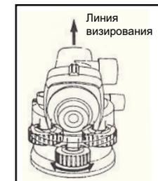
**Рекомендуется проверять поведение компенсатора прибора каждый раз перед началом работы.**
