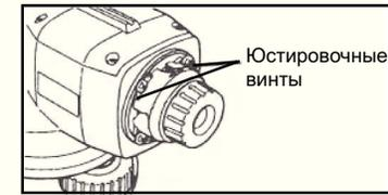
4. Если разность между  $b2,$  и  $b2$  положительна (отрицательна), горизонтальная нить должна быть поднята (опущена). Чтобы поднять горизонтальную нить, сначала несколько ослабьте нижний юстировочный винт, а затем аккуратно затяните верхний юстировочный винт на ту же величину. Определите новое значение разности  $b2,$  -  $b2$  и , в случае необходимости, повторите юстировку.
