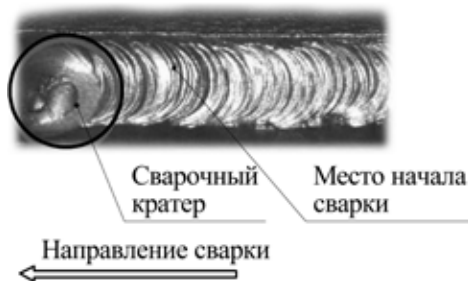
Рис. 10.4. Начало сварки при смене электрода.
