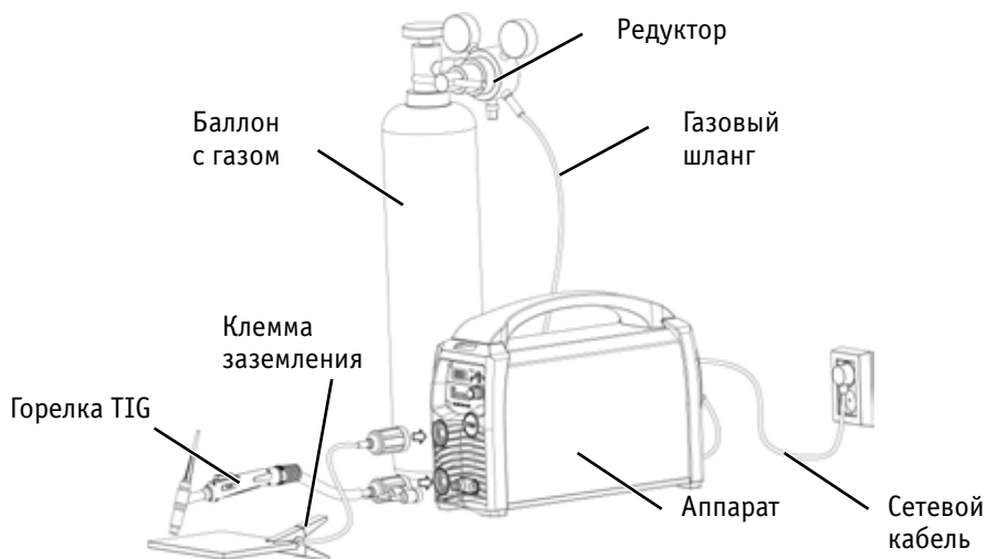
Рис. 8.1. Схема подключения оборудования.
