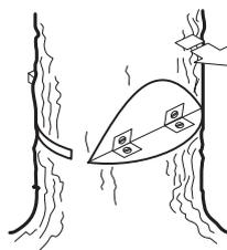
Возможность влияния на направление падения будет полностью утрачена, если полоса разлома слишком узкая или пропилована направляющий и основной пропилами плохо размещены.
