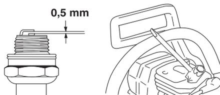
Обратите внимание! Всегда используйте только указанный тип свечи! Применение несоответствующей модели может привести к серьезным повреждениям поршня/цилиндра. Следите за тем, чтобы свеча была оснащена т.н. изоляцией радиопомех.
