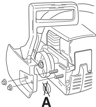
Установите пильное полотно на специально предназначенные болты. Установите полотно в самое заднее положение. Наденьте цепь на ведущую звездочку и вставьте ее хвостовики в паз пильного полотна. Начинать с верхней стороны пильного полотна. Убедитесь, что кромки режущих звеньев направлены вперед на верхней стороне пильного полотна.
