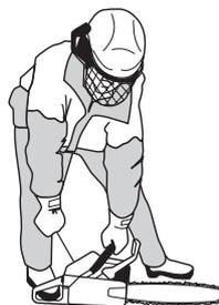
Так как тормоз цепи по-прежнему включен, двигатель должен как можно скорее быть переведен на холостые обороты, что может быть достигнуто за счет быстрого выключения ограничителя газа. Тем самым Вы избежите ненужного износа сцепления, барабана сцепления и тормозной ленты.
