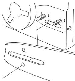
Для этого поверните винт механизма регулировки цепи по часовой стрелке. Цепь следует натягивать до тех пор, пока она не будет плотно прилегать к нижней стороне пильного полотна.
