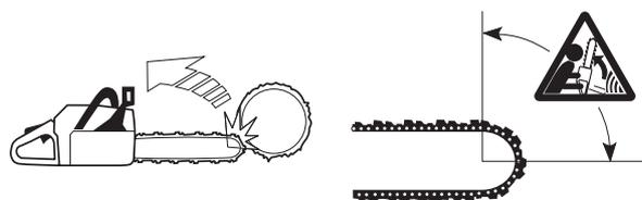
Резка нижней кромкой полотна, т.е. от поверхности объекта к нижнему краю известна как пиление с нажимом. В этом случае моторная пила сама наезжает на дерево и передний край моторной пилы соответствует естественному положению при резке. Пиление с нажимом обеспечивает лучший контроль над моторной пилой и расположением области отдачи.
