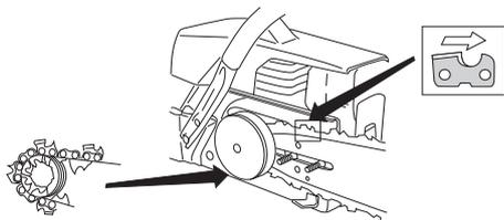
Установите штифт механизма натяжения цепи в специальное отверстие на пильном полотне и оденьте крышку сцепления. Проверьте правильность установки хвостовиков цепи на
