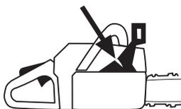
Сдвиньте ручку тормоза вперед и назад, удостоверьтесь, что она перемещается свободно, и надежно фиксируется на крышке сцепления.
