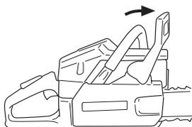
**Зажигание:** Установите переключатель зажигания в левое положение.
