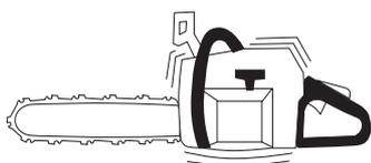
Проверьте, чтобы виброгасящие элементы были надежно закреплены на блоке двигателя и ручках.
