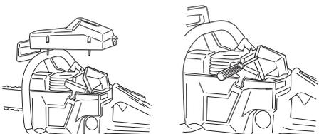
Для более тщательной чистки фильтр следует помыть в воде с мылом.
