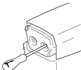
В некоторых глушителях предусмотрен специальный искрогаситель. Если ваша машина оборудована таким глушителем, сетку фильтра следует чистить раз в неделю. Наилучшие пользователи стальной щеткой. Забитая решетка приводит к работе с горячим двигателем, что дает серьезные повреждения двигателя.
