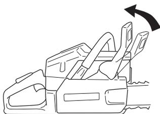
Отвинтите гайки крепления пильного полотна и снимите крышку муфты сцепления (тормоза цепи). Снимите транспортировочное кольцо (А).
