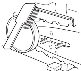
Регулярно проверяйте, чтобы лента тормоза была по крайней мере толщиной минимал 0.6 мм в самом изношенном месте.
