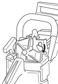
**ВАЖНО!** При повышении температуры выше  $-5^{\circ}\text{C}$  и соответственно  $0^{\circ}\text{C}$  машине пила ДОЛЖНА быть отрегулирована для работы в нормальных условиях. Иначе может произойти перегревание, последствием которого может быть сильное повреждение двигателя.
