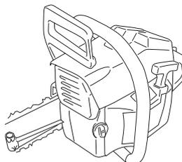
Цепь считается натянутой правильно, если она свободно проворачивается рукой. После этого, удерживая носок пильного полотна в верхнем положении, затяните гайки крепления пильного полотна универсальным ключом.
