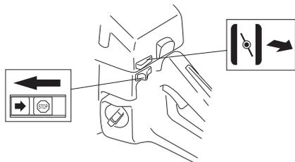
Если машина оборудована декомпрессионным клапаном (А): Его необходимо нажать, чтобы уменьшить давление в цилиндре и облегчить запуск машины. При запуске машины всегда
