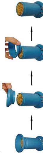
**Прибор при измерении исходит из расчёта, что измерительную чашу насыпан ровно мерный объём. При отличии измеряемого объёма материала от мерного – будет ошибка в измерении. Исходные калибровки программ расчитаны на то, что насыпанный в мерный объём материал не утрясается и нетрамбуется.**
