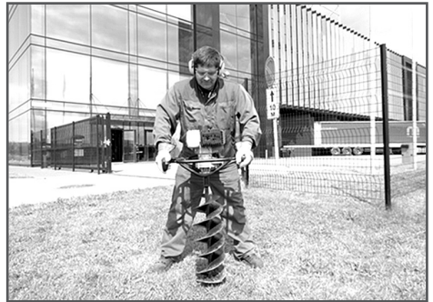
Рис. 8. Положение тела оператора при работе мотобуром
