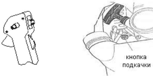
Рис. 8. Акселератор и праймер для подкачки топлива
