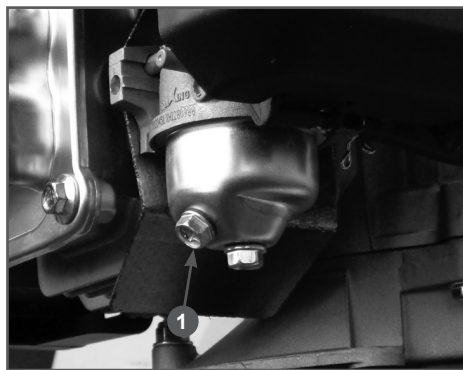
Рис. 19 Слив топлива из карбюратора
